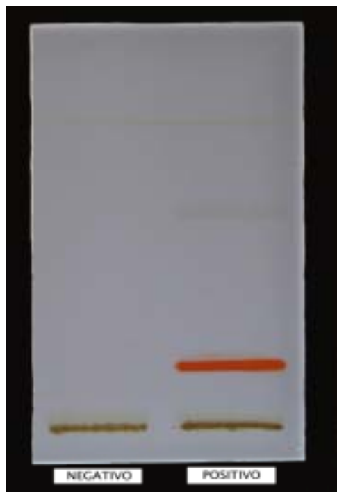
Fig.8; cromatografia su strato sottile che evidenzia alla luce naturale la presenza del colorante RSI su un campione di peperoncino in polvere.
